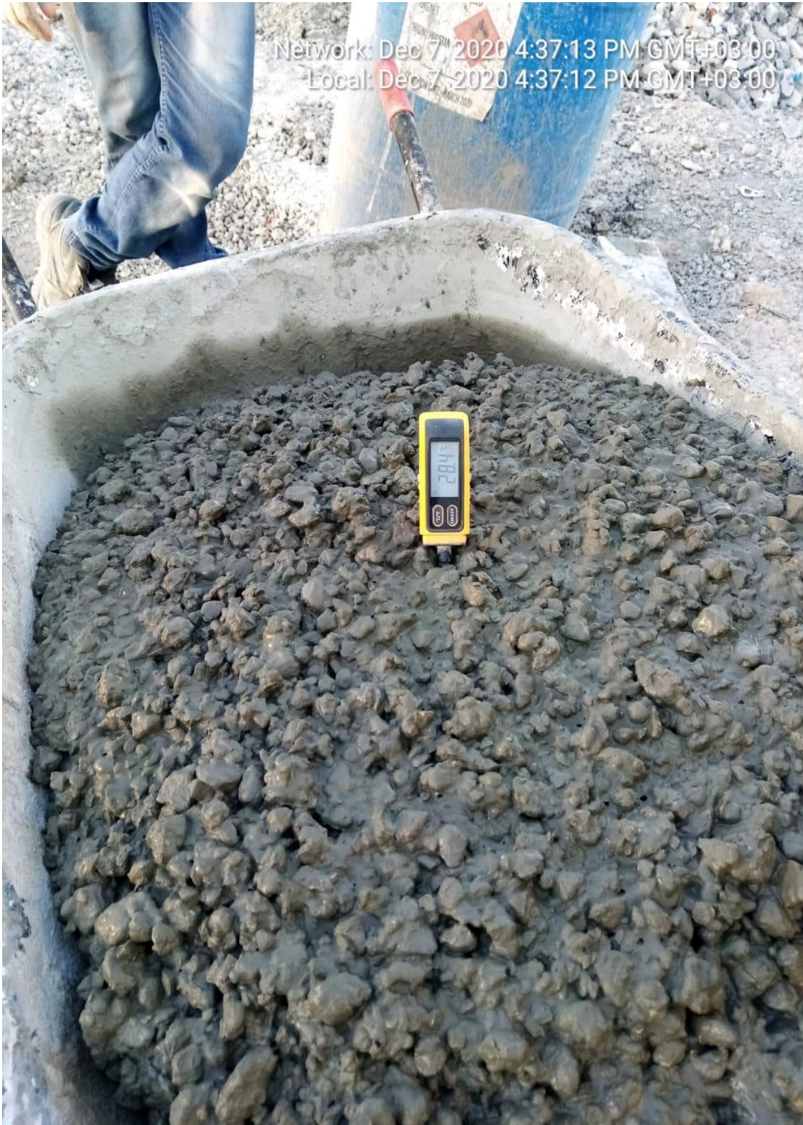
(شكل رقم 22) يوضح اختبار درجة الحرارة
