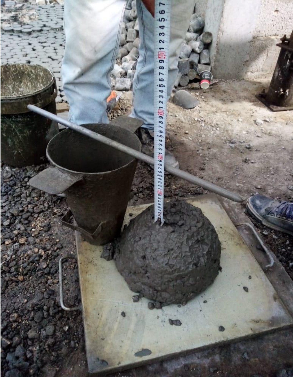
(شكل رقم 21) يبين اختبار القوام للخرسانة
