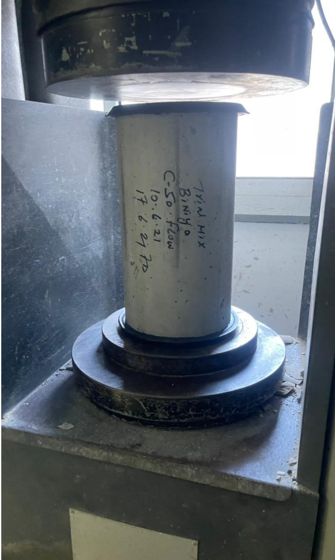
(شكل رقم 25) يوضح وضع العينة بعد 28 يوم على جهاز التكسير
