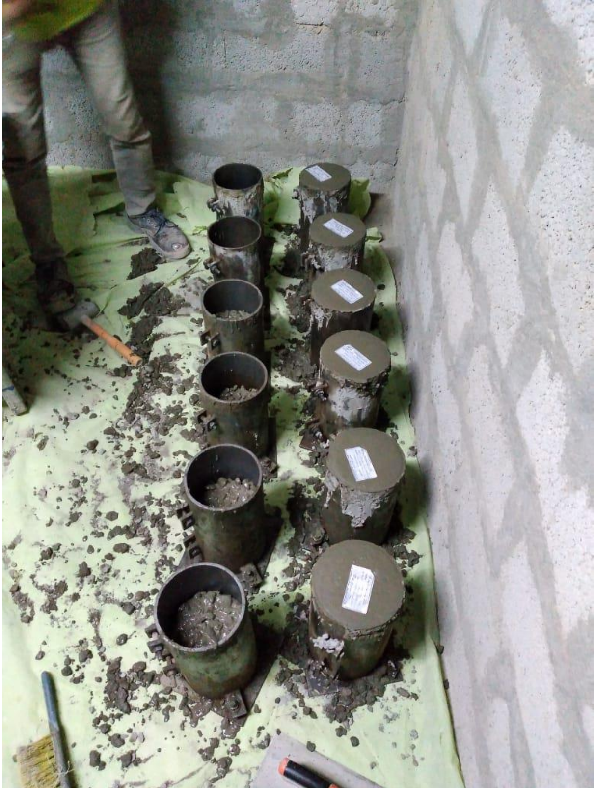
(شكل رقم 24) يبين عمل عينات (Cylinders) من الخرسانة الطازجة لكسرها بعد التصلد لفترة 7 ايام وفترة 28 يوم
