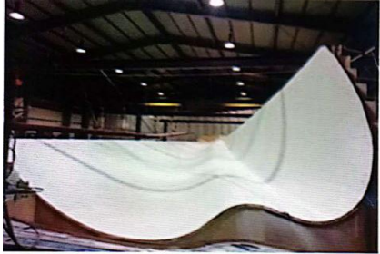
(شكل 18) يوضح الألياف الزجاجية وقالب الصب ثم تجهيز سطح القالب بمادة الجليكوت وهي الطبقة الناعمة
