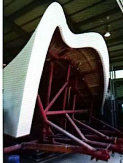
(شكل 19) يتضح من خلاله التشطيب النهائي لخامة الفايبرجلاس بعد طلاؤها بالتيتانيوم وتجهيزها للتركيب
