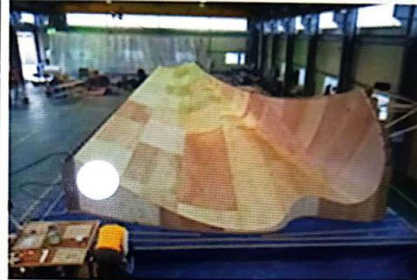
(شكل 18) يوضح الألياف الزجاجية وقالب الصب ثم تجهيز سطح القالب بمادة الجليكوت وهي الطبقة الناعمة
