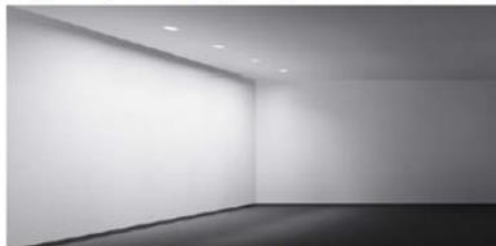
إنارة غير مباشرة ناتجة عن أجهزة إنارة غاطسة في السقف وتنتير الجدار ويسمى الجهاز بمنتير الجدار (وال واشتر) Wallwasher
