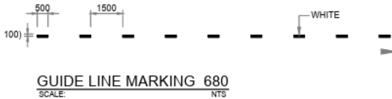
الشكل (6-42) - يوضح خطوط اتجاه الحركة الارشادي - بحسب الكود المحلي
